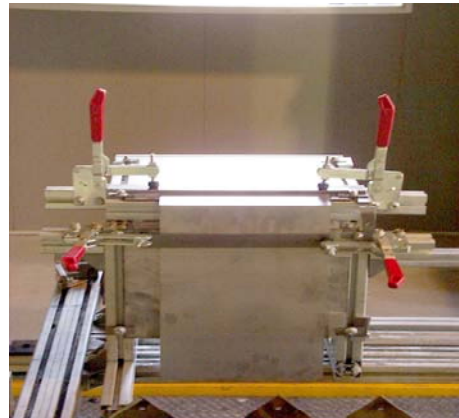
Fig. 4.6: Utillaje experimental para la soldadura de probetas en chapa plana
