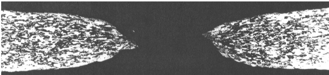
Fig. 6.12: Detalle de la zona de rotura de una muestra sometida a ensayo de embutición (x40)
