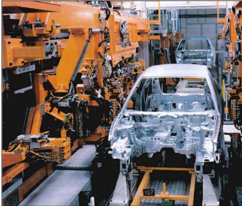
Fig. 4.2 Interior de la cabina de soldadura de los modelos Ibiza y Córdoba
