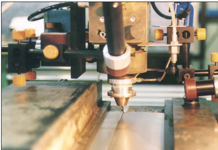
Fig. 6.27: Vista frontal de la disposición de los detectores.
