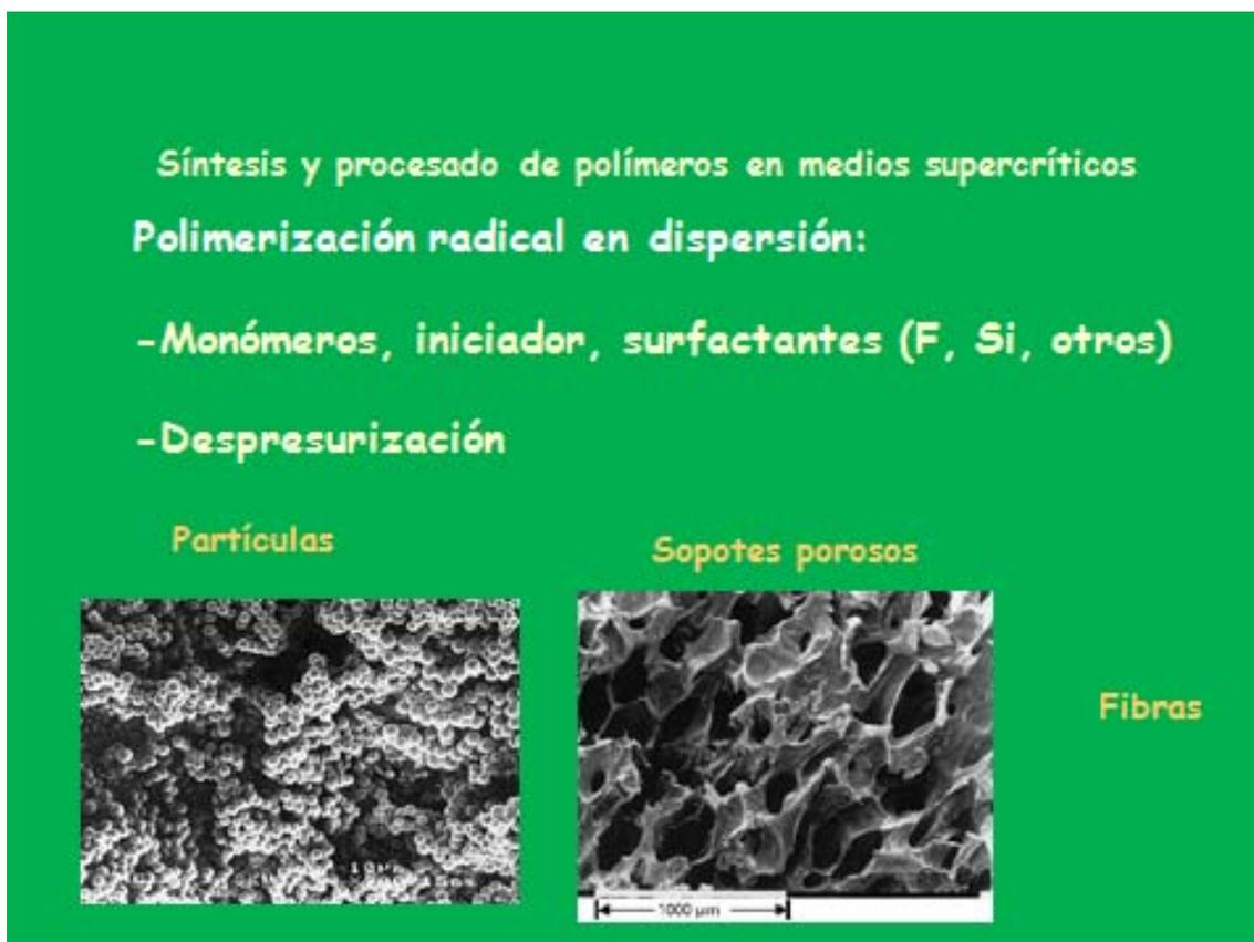
Figura 10: Sistemas nanoparticulados y sistemas porosos preparados por polimerización de metacrilato de metilo en condiciones de CO<sub>2</sub> supercrítico.
