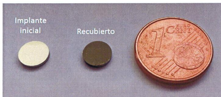
Fig. 34: Fotografía mostrando dos discos de Ti6Al4V de 4mm de diámetro, uno sin recubrir y otro recubierto con nanocolumnas de Ti, que se emplearán en los ensayos in vivo.
