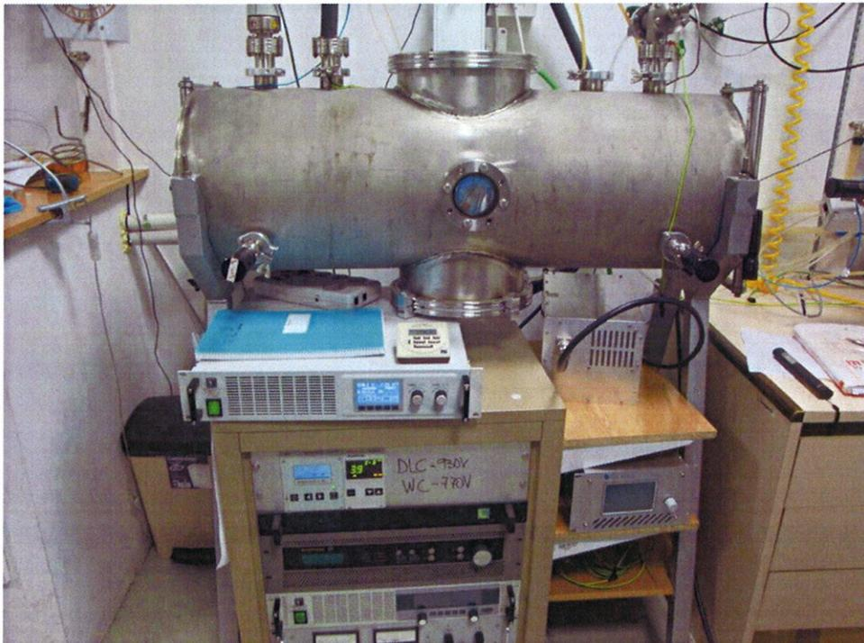
Fig. 15: Equipo industrial de sputtering de Nano4Energy empleado para recubrir implantes ortopédicos.
