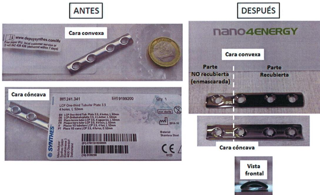
Fig. 30: Fotografías de la placa de fijación tubular que tiene 5.2 cm de largo y 0.9 cm de ancho, en su estado inicial antes de ser recubierta y en su estado final después del proceso de sputtering.
