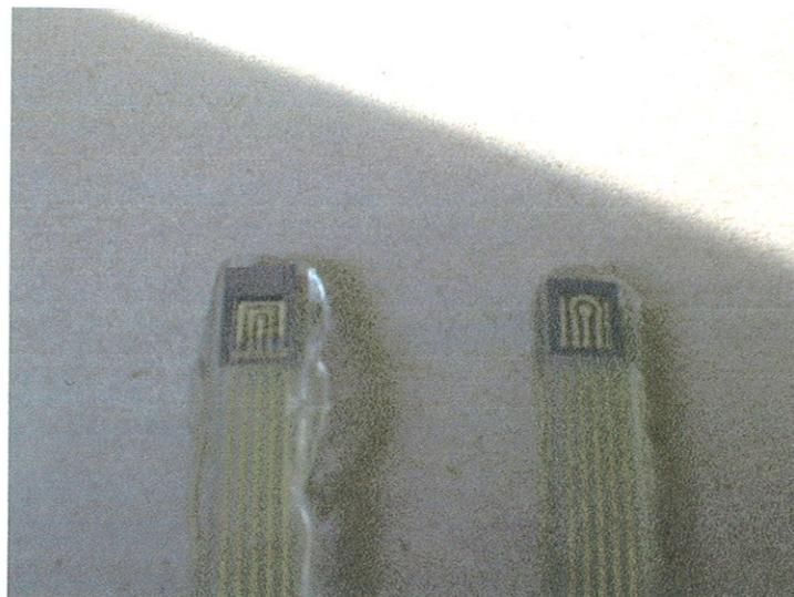
**Figura 1b.** Foto de dos sensores amperométrico de platino desarrollados en el presente trabajo.
