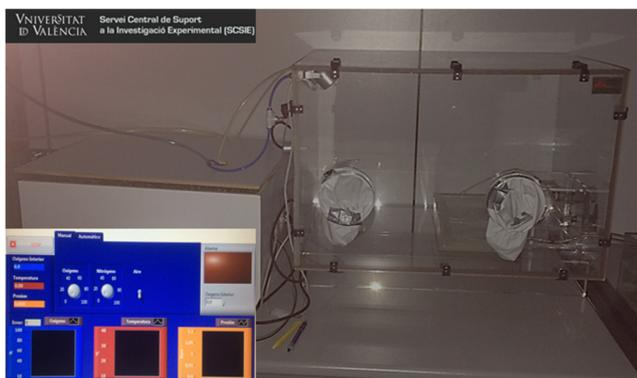
**Figura 14.** Imagen de la estación de gases diseñada para los experimentos de hipoxia e hiperoxia *in vivo* (SCSIE-UV). El equipo permite el control y monitorización de la temperatura, las presiones de gases y humedad.
